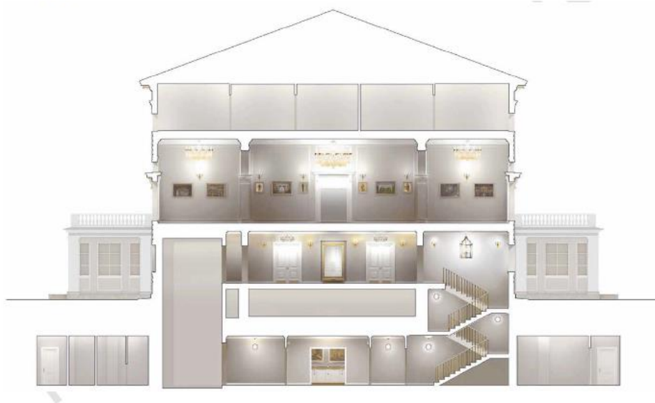
68. Каменноостровский театр. Проект реставрации приспособления для современного использования. 2007-2011 гг. Поперечный разрез по вестибюлю и фойе. Опубликовано в: Дементьева В.А., Рахманов В.С., Шашкин А.Г., Бурыгин В.А. Каменноостровский театр. Синтез достижений реставрации и геотехники». (авторы:). СПб., 2014.
