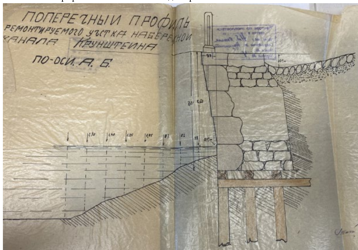
Илл. 20. Проект ремонта каменной части набережной. Деформированный участок. Разрез. 1934 г. (Архив СПб ГБУ «Мостотрест»)
