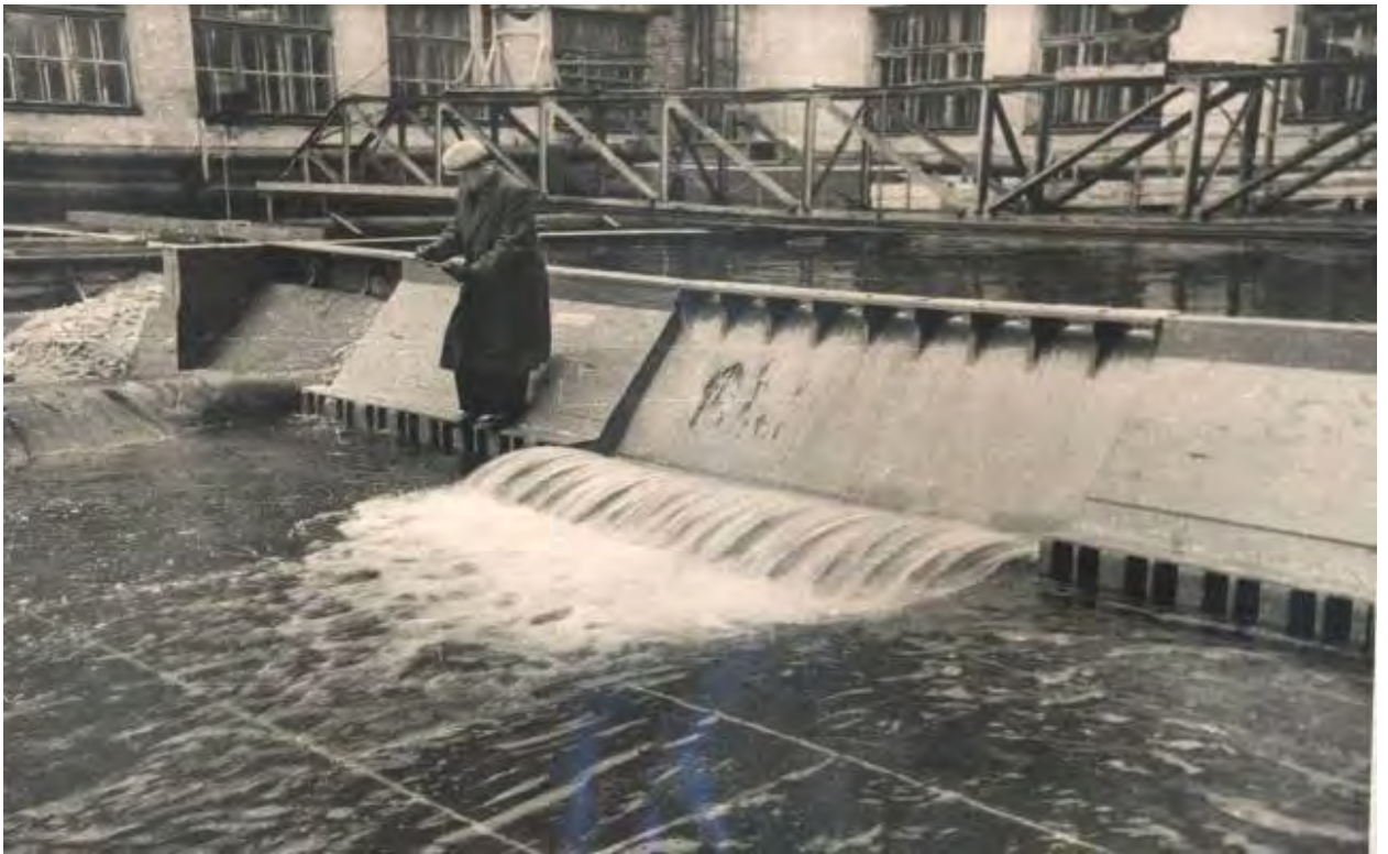
54. Проверка работы братской ГЭС по модели. Фото 1954-х гг. По материалам музея ОАО ВНИИГ им. Б.Е. Веденеева.
