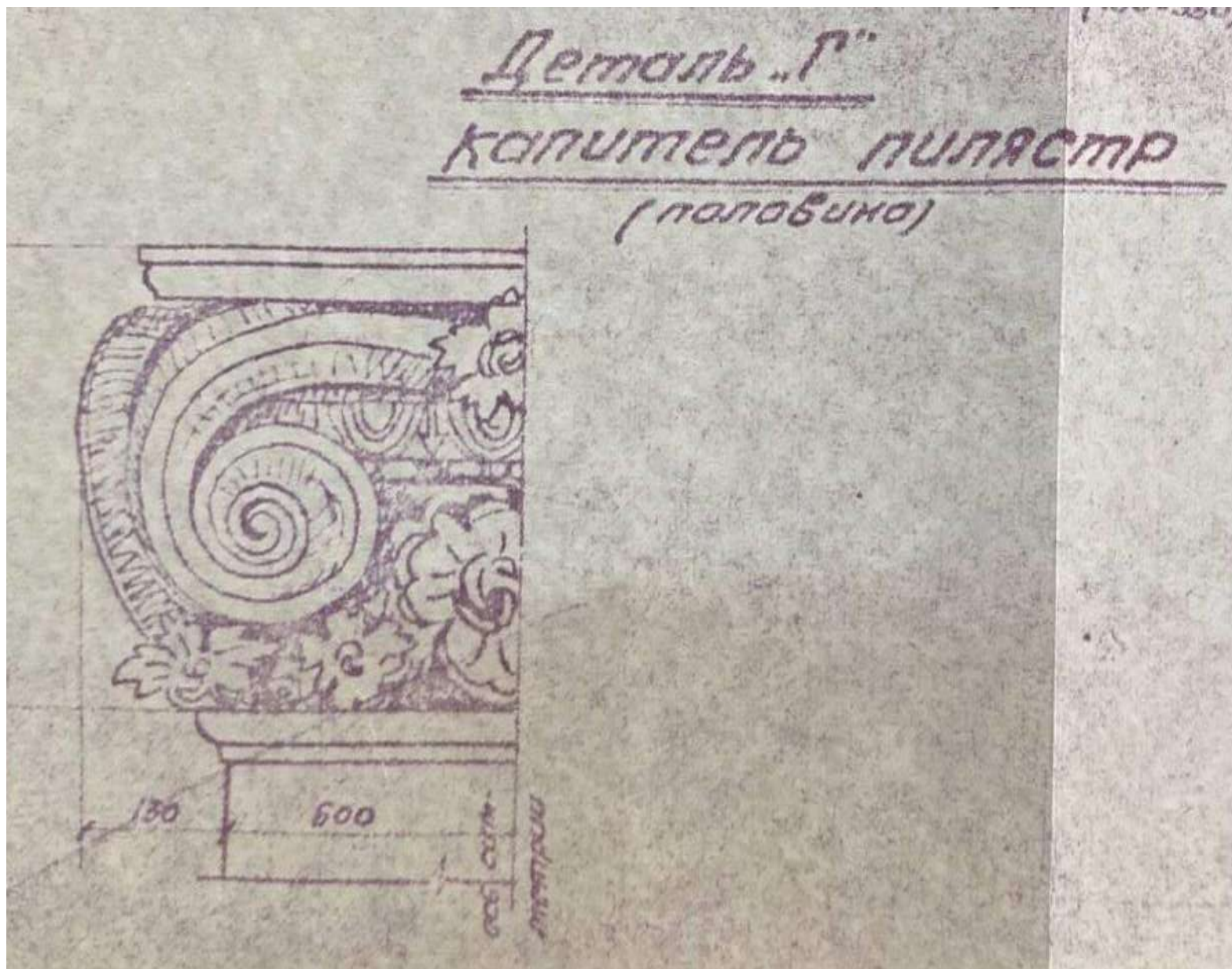
113. Малый дворец. Деталь «Г». Капитель пилястр. 1898 г. // Архив КГИОП. 271-1-5. Пр-2. Всесоюзный НИИ токов высокой частоты им. В.П. Вологодина. Альбом чертежей к паспорту. Малый дворец.
