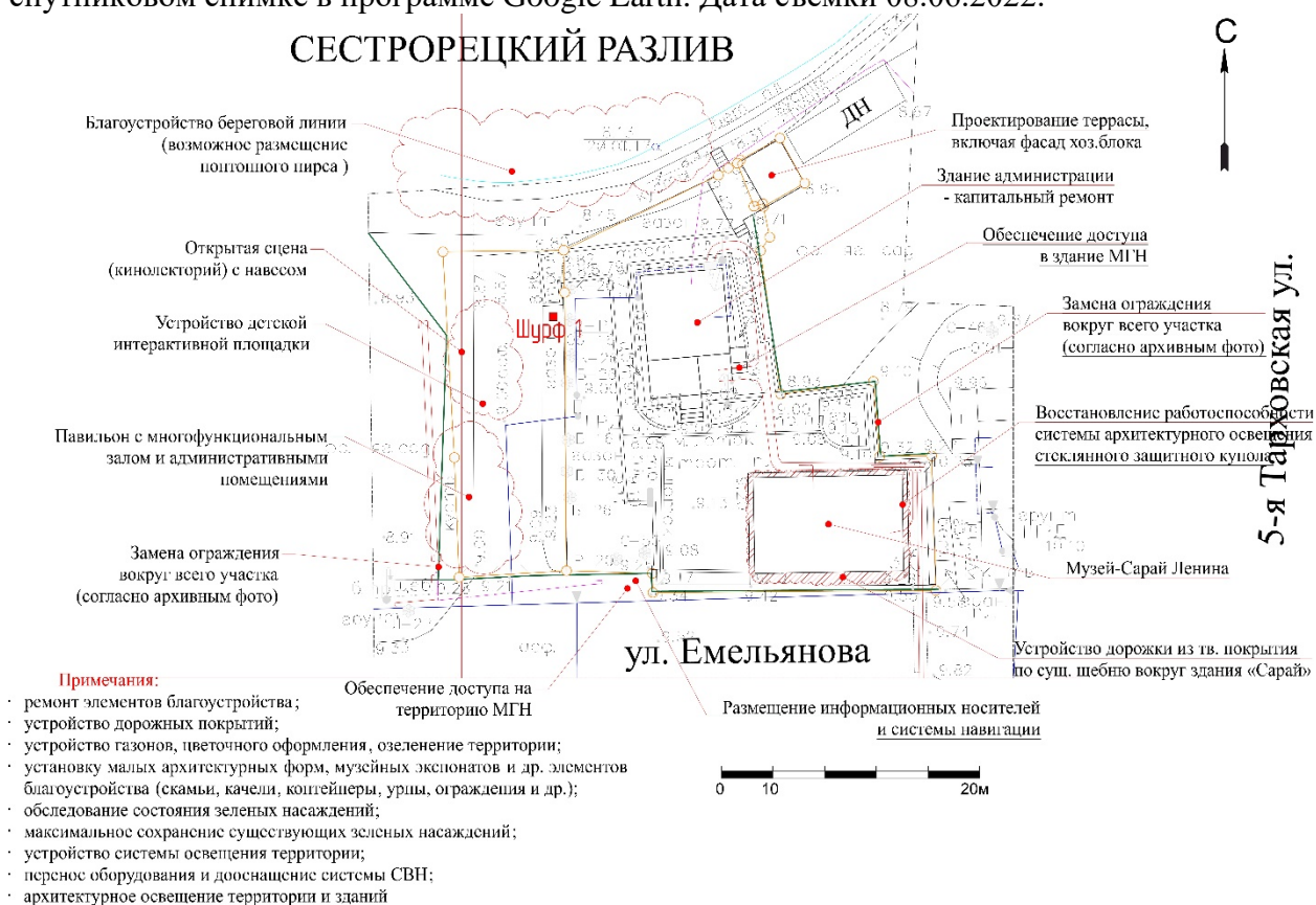
Рис. 6. Санкт-Петербург, Сестрорецк, "Сарай Н.А. Емельянова"-2024. Расположение шурфа (Шурф 1) на топографическом плане объекта обследования, предоставленном Заказчиком.
