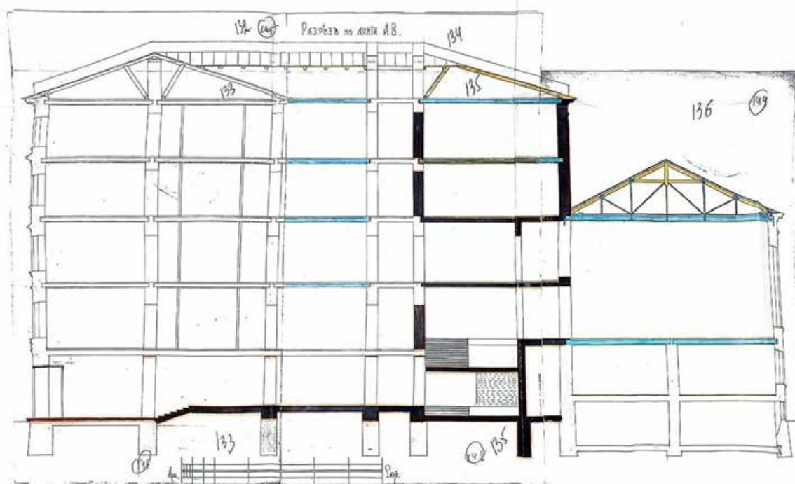
24. ЦГИА СПб. Ф.513 Оп.102 Д.4682 Л.132,136. Разрез по линии АВ. Устройство лестницы спуска из ресторана во дворовой части и выходом на Владимирский пр. дворового флигеля дома Надворного советника П.К. Палкина. Проект. Архитектор А.С. Хренов. 5 июня 1904 г.
