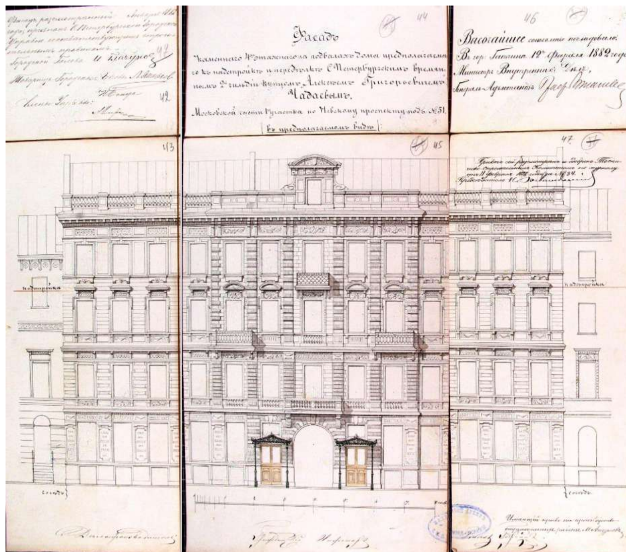
37. Фасад каменного 4-этажного на подвалах дома предполагаемого к надстройке и перестройке С.Петербургского временного 2-й гильдии купца Алексея Григорьевича Чадаева Московской части 1 участка по Невскому проспекту под №51 в предполагаемом виде. 1882 г. // Источник: ЦГИА СПб Ф. 515 Оп. 4 Д. 3904 Л. 42-47.
