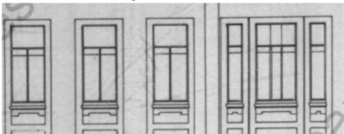
Рис. 1. Историческое оконное заполнение дворового фасада. Чертежи дома В.В.Змеева, И.И.Круглова по Невскому пр.,147. ЦГИА СПб. Фонд 515. Опись 4. Дело 3953
