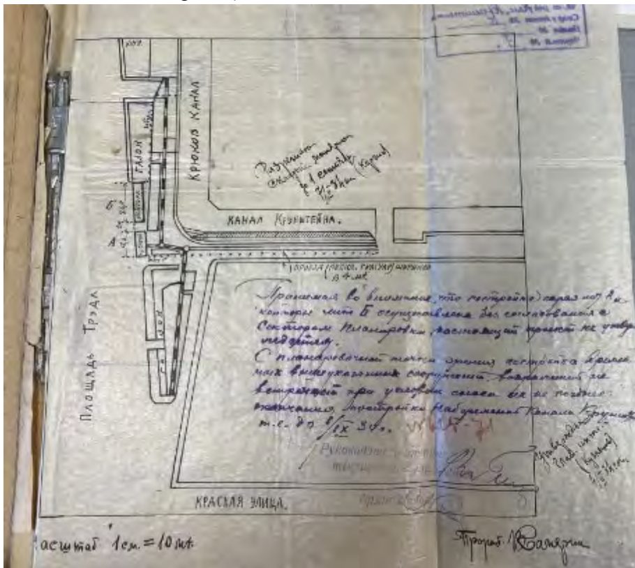
Илл. 22. Проект ремонта каменной части набережной. План. 1934 г. (Архив СПб ГБУ «Мостотрест»)
