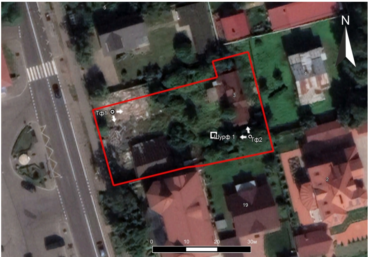
Илл. 19. Санкт-Петербург, Коннолахтинский проспект, дом 3, литера А. Расположение точек фотофиксации и шурфов. Спутниковый снимок Google 2022 г. Участок обследования обозначен красным цветом. Белым квадратом обозначено место закладки шурфа, белыми стрелками – точки фотофиксации.
