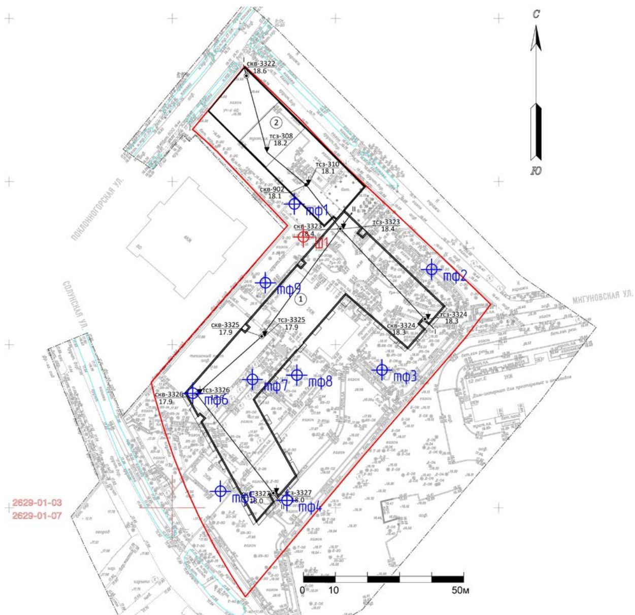
Илл. 35. Санкт-Петербург, Поклонногорская улица, земельный участок 48а. Топоплан участка с коммуникациями (чертеж предоставлен заказчиком) и месторасположение разведочного шурфа. Съёмка – март 2021 г. Участок обследования обозначен красным цветом. Красным крестом обозначено место закладки шурфа, синими крестами – точки фотофиксации.
