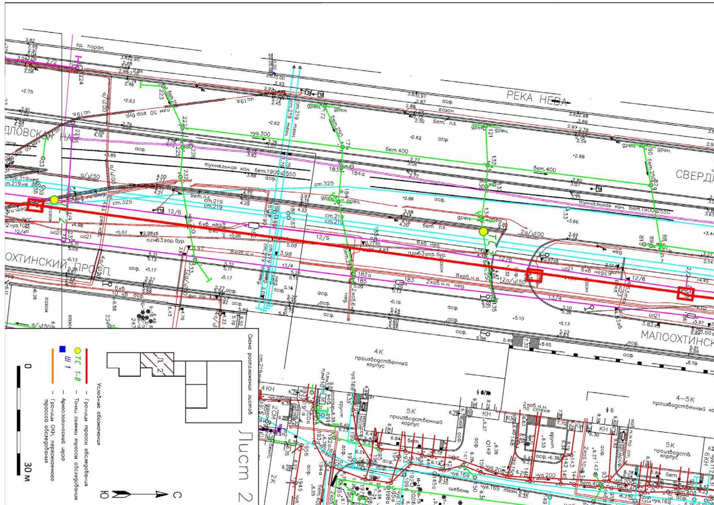
Рис. 15. Санкт-Петербург, Красногвардейский район, Красногвардейская площадь. Топографический план участка обследования с указанием мест заложения шурфов, точек съемки общих видов участка обследования (Лист 2).
