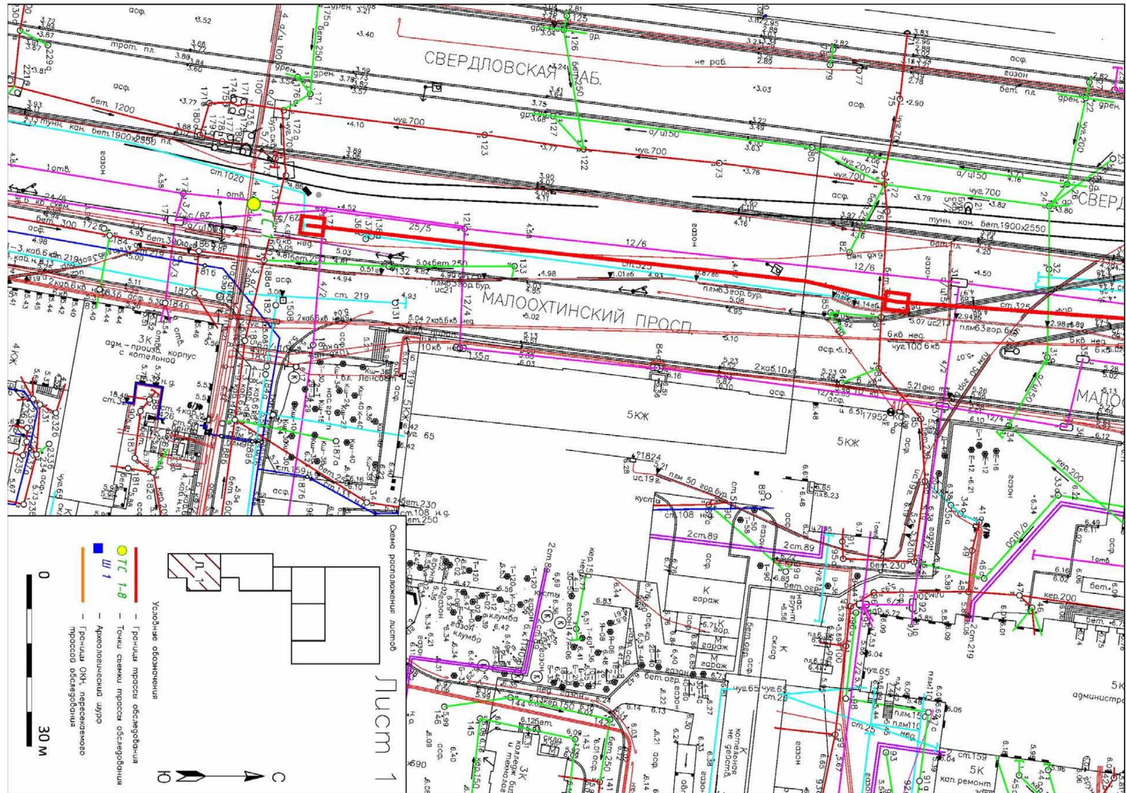
Рис. 14. Санкт-Петербург, Красногвардейский район, Красногвардейская площадь. Топографический план участка обследования с указанием мест заложения шурфов, точек съемки общих видов участка обследования (Лист 1).
