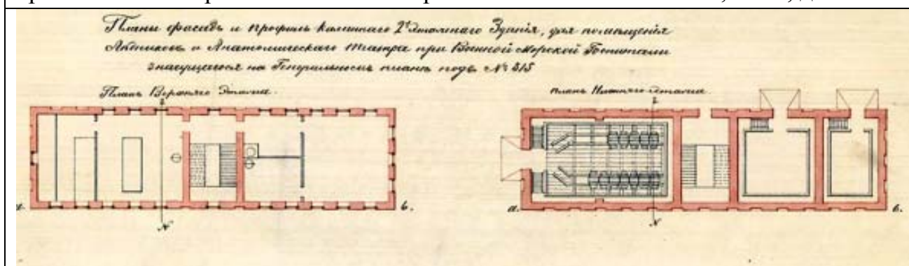
9. «План, профиль и фасад каменного 2-хэтажного здания для ледников и Анатомического театра при Военной Морской госпитали с показанием значащимся на генеральном плане под № 315». Фрагмент. Планы верхнего и нижнего этажей. РГА ВМФ Ф. 326, оп. 1, д. 6221.
