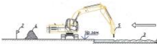
Схема демонтажа дорожных конструкций
