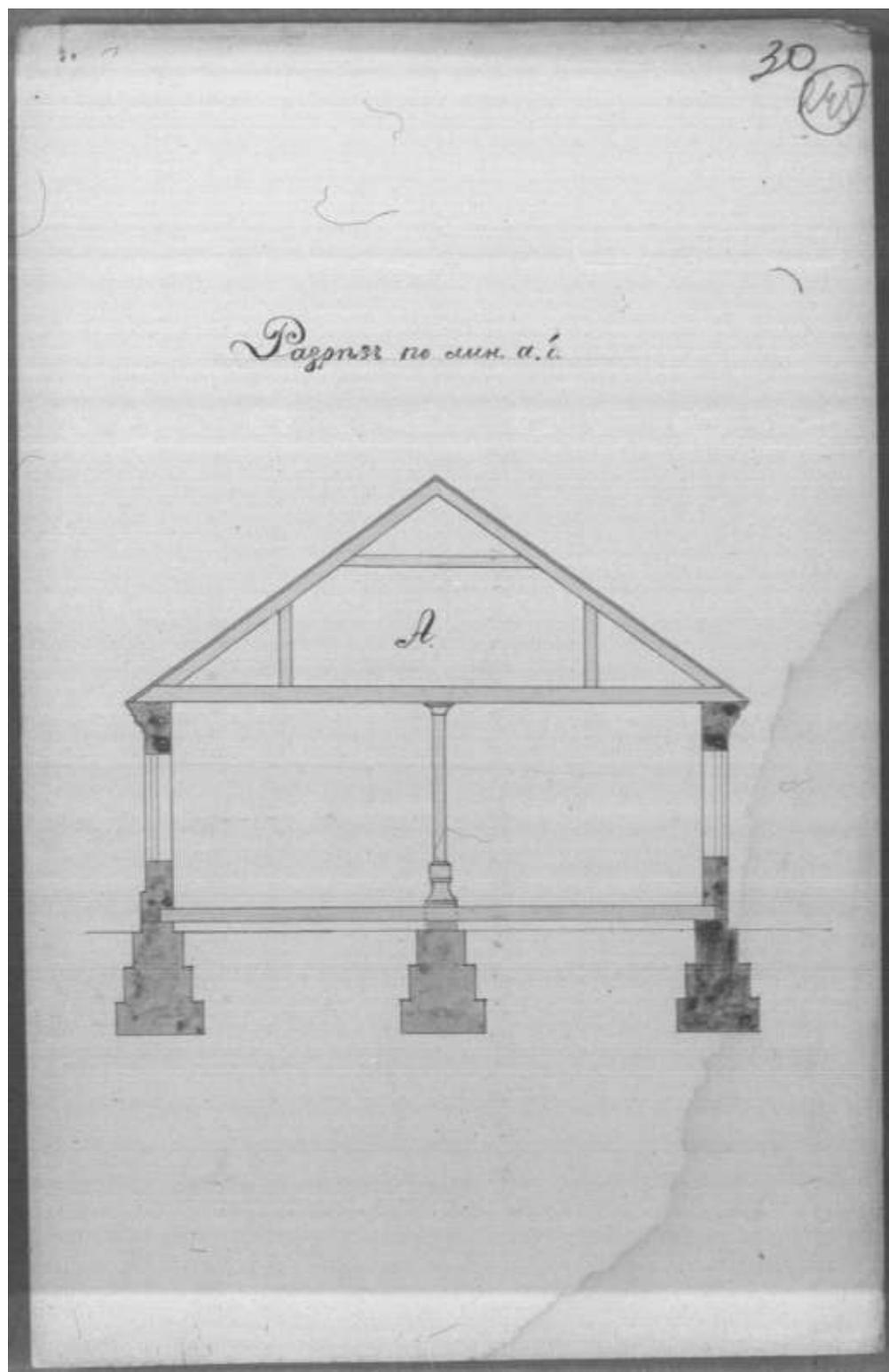
17. Разрез производственного корпуса. 1883 г.
