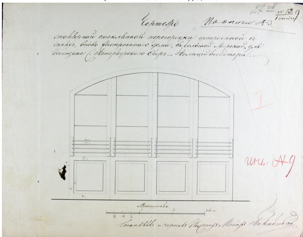
Илл. 30. Чертеж стеклянной перегородки, установленной в сенях вновь выстроенного дома для господина обер-полицеймейстера. 1848 г. — ЦГИА СПб. Ф. 513. Оп. 101. Д. 3, л. 27об.
