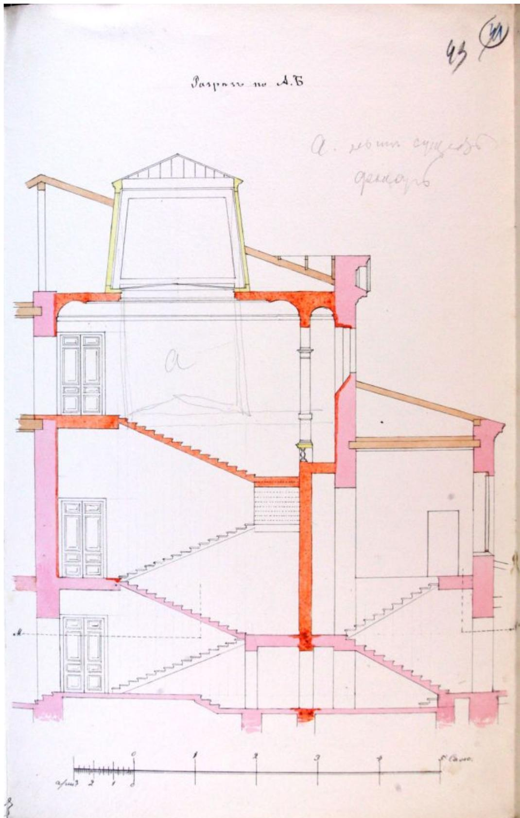
Илл. 20. Проект надстройки парадной лестницы. Разрез. 6 апреля 1889 г. Архитектор А. Р. Гешвенд. ЦГИА СПб. Ф.513. Ф.102. Д.3383. Л. 43.
