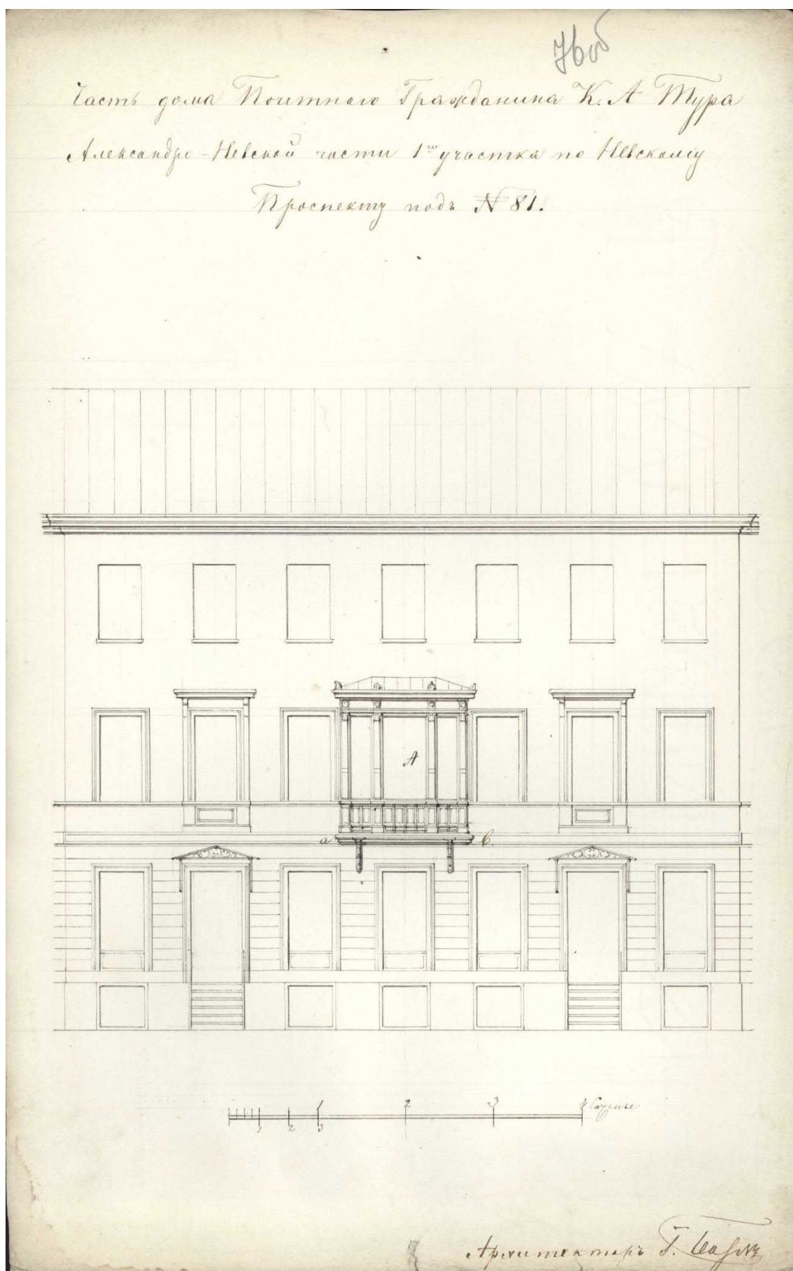
Илл. 5. Чертеж устройства эркера. ЦГИА СПб. Ф. 513. Оп. 102. Д. 712
