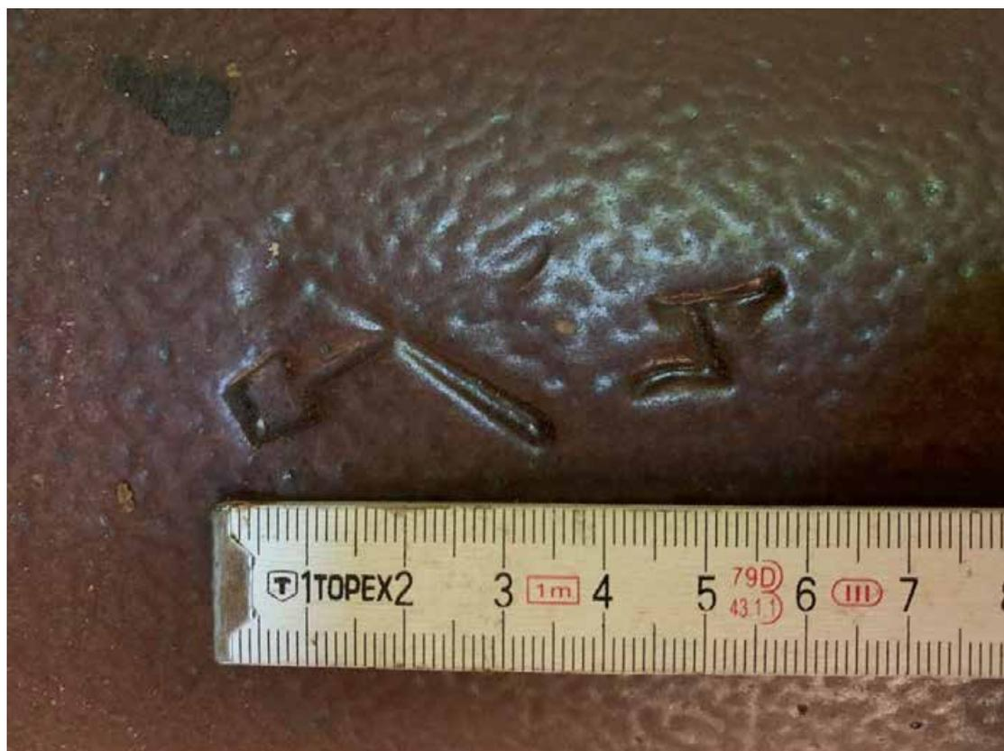
Рис. 118. Санкт-Петербург, Центральный район, Ул. Ломоносова, д. 9. Шурф 2. Объект 4. Клеймо секции трубопровода.
