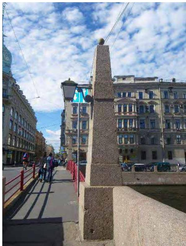
четырёхгранные фонари матового стекла; нижние крышки с литым орнаментом из розетты и четырех акантовых кронштейнах; над стеклами вставки растительного рисунка; верхние крышки - с шишкой в завершении; детали фонарей и кронштейнов бронзированы;
