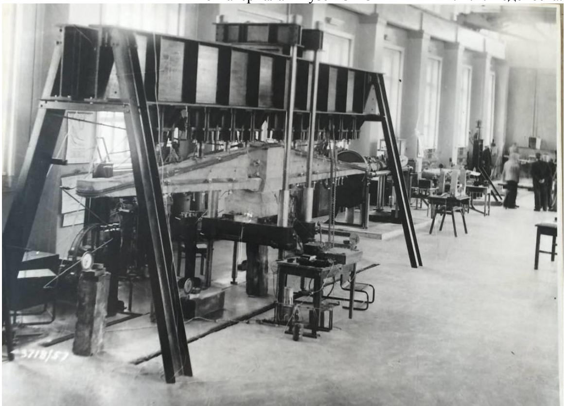
62. Испытание моделей подпорных стен. 1960-е гг. По материалам музея ОАО ВНИИГ им. Б.Е. Веденеева.
