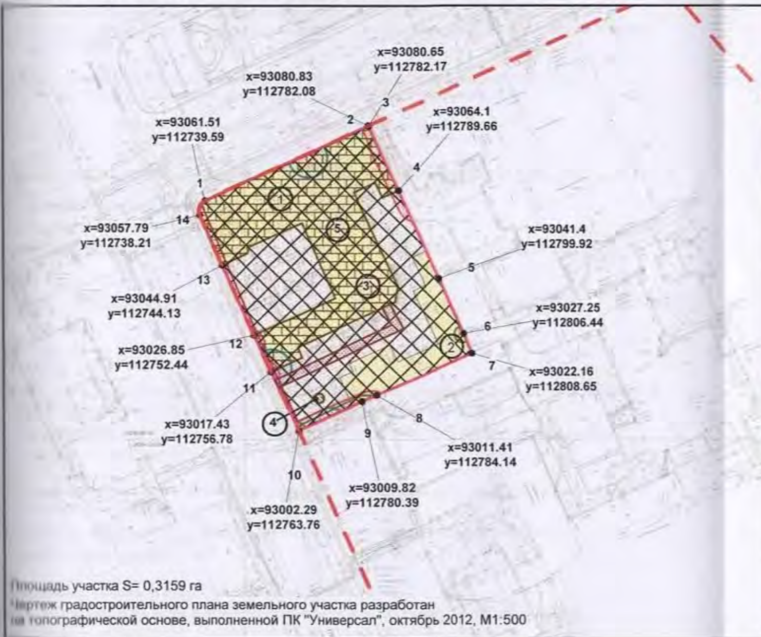
Схема расположения земельного участка в окружении смежно расположенных земельных участков (ситуационный план) М 1:2000
