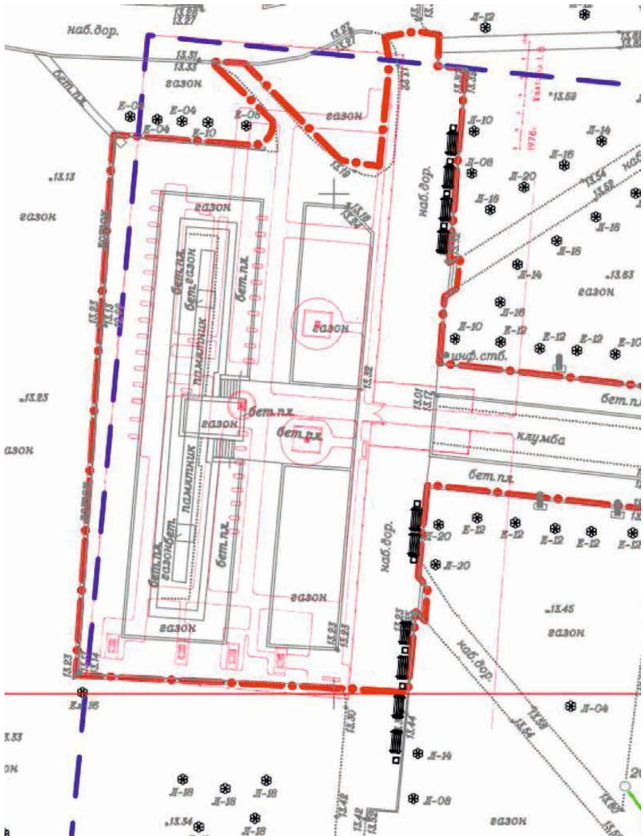
Ил. 12. Совмещенный архитектурно-планировочный обмер 1978 г. и топосъемка 2020 г.
