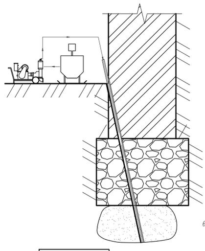
6) Ликвидация скважин: срезка металлической трубы  $\varnothing 42 \times 3$  мм заподлицо со стеной, заполнение трубы-инъектора тампонажным цементным раствором.
