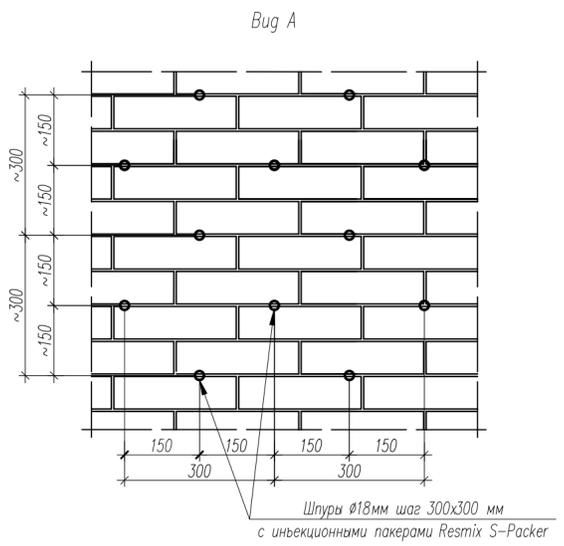
Порядок производства работ по сплошному усилению кирпичных стен и сводов.
