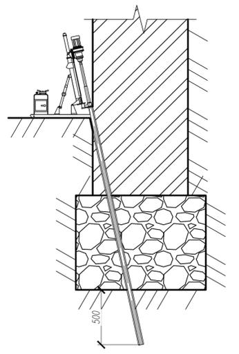
**2 ЭТАП**      **2. Заполнение скважин тампонажным (обойменным) раствором**
