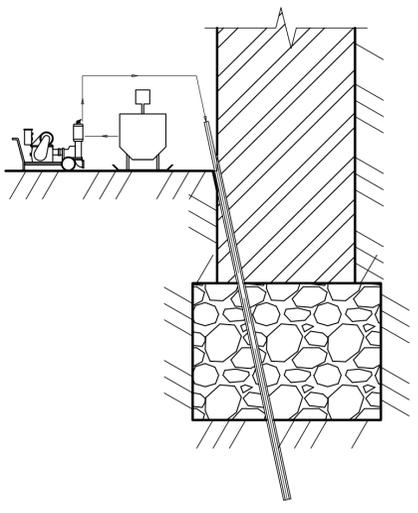
**2 ЭТАП**      **3. Спуск в скважину трубы-инъектора из металлической трубы Ø42x3 мм**
