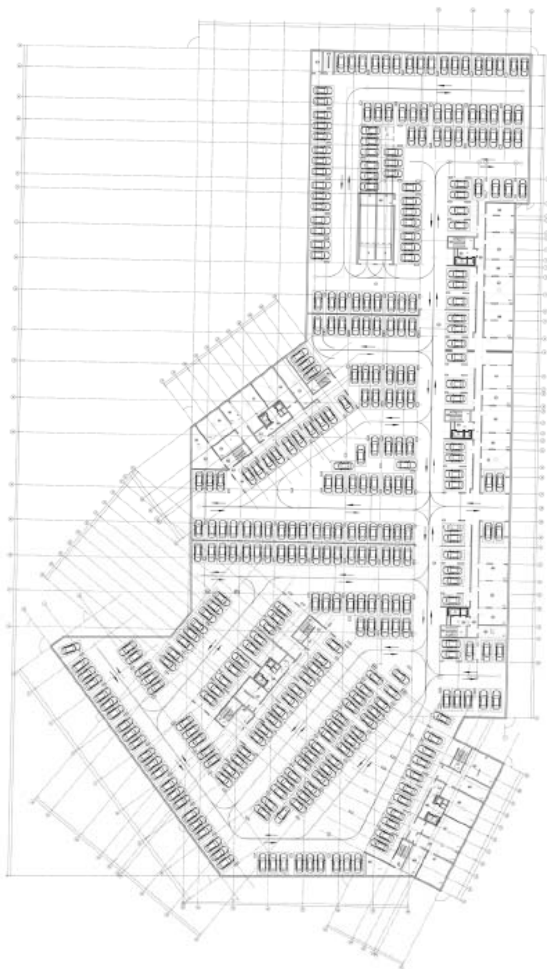
Илл. 14 - План подземного этажа на отметке -4,800.
