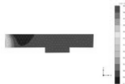
Илл. 199 - Изополя осадок фундаментов сохраняемого ОКН «Здание инструментального цеха» по адресу: наб. Обводного канала, д. 118а, лит. Н по итогам устройства 1-го (верхнего) уровня распорной системы и разработки части грунтовых берм, сохраняемых вдоль периметра шпунтового ограждения. S_{don4}=0,19 мм. Полученная дополнительная осадка не превышает требований ТСН 50-302-2004 (20мм).
