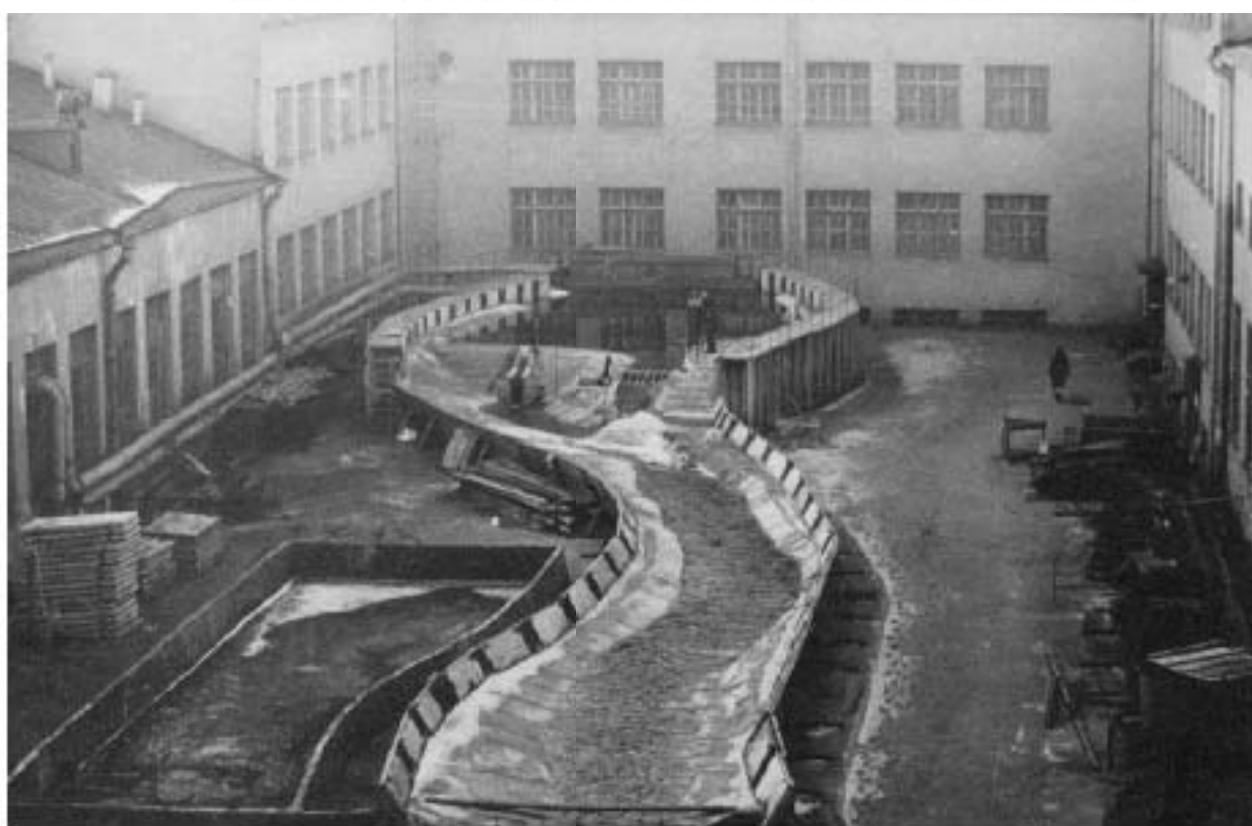
65. Модель Колымского гидроузла на открытой площадке. М 1:100. 1974 г. По материалам музея ОАО ВНИИГ им. Б.Е. Веденеева
