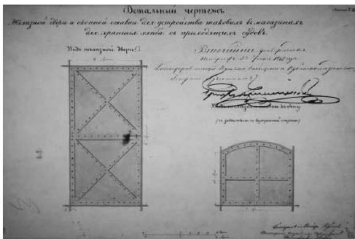
Илл. 7. Детальный чертеж железной двери и оконной ставни для устройства таковых в магазинах для хранения хлеба. Утвержден 9 июня 1847 г. РГИА. Ф. 815. Оп. 12. Д. 79.
