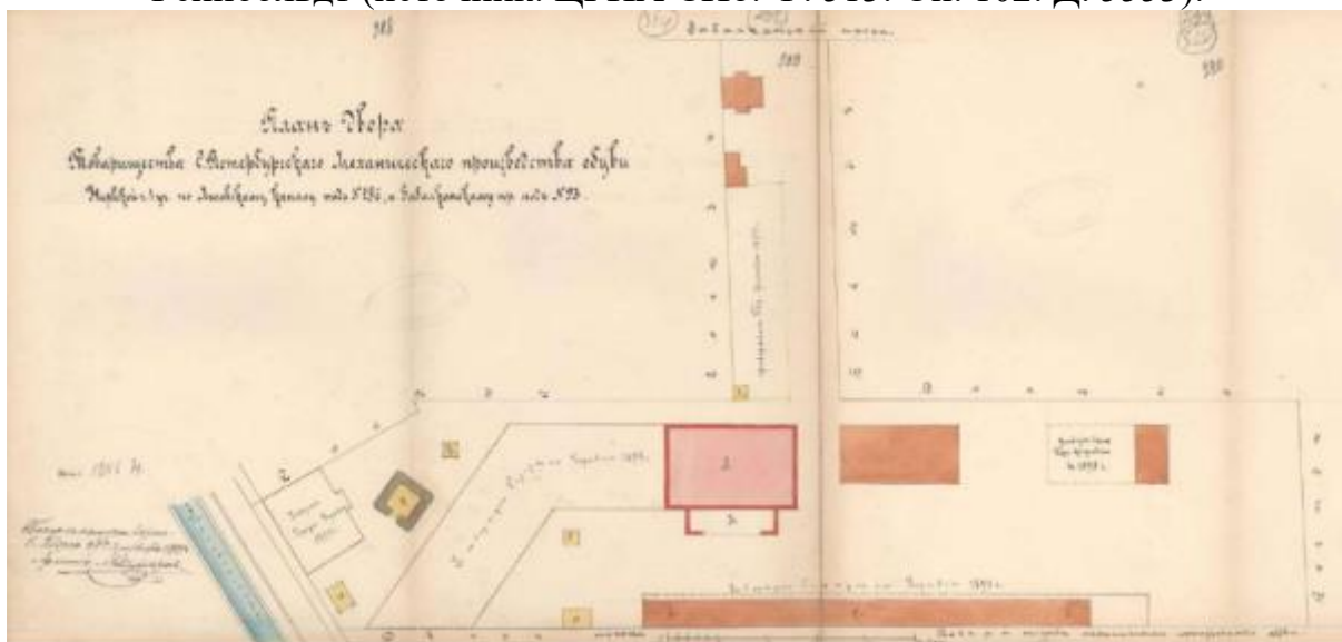
Илл. 33. План двора Товарищества С.Петербургского механического производства обуви. Надстройка вторым этажом флигеля лит. А с пристройкой навеса под лит. В Кожевенного завода лит. А. 1898 г. Арх. Рейнбольдт (источник: ЦГИА СПб. Ф. 513. Оп. 102. Д. 5553).
