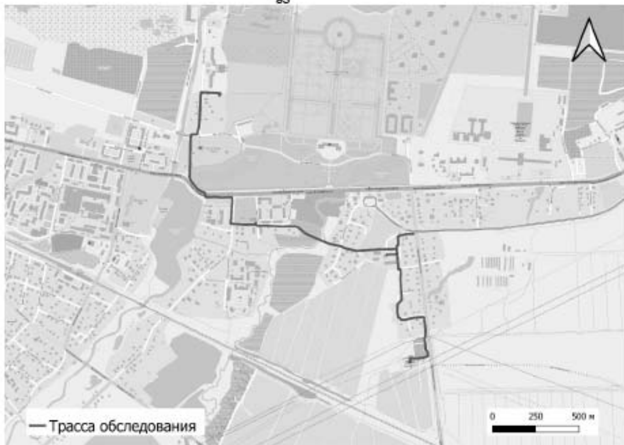
Рис. 2. «Реконструкция КЛ-6 кВ Ф.65-6 Л ПС-250 в части замены трассы КЛ на кабель из спитого ПЭ ориентировочной протяженностью 3,08 км» и «Реконструкция КЛ-6 кВ Ф.65-3 Л ПС-250 в части замены трассы КЛ на кабель из спитого ПЭ ориентировочной протяженностью 3,08 км». Расположение трассы обследования на карте поселка Стрельна Петродворцового р-на Санкт-Петербурга. (OSM)
