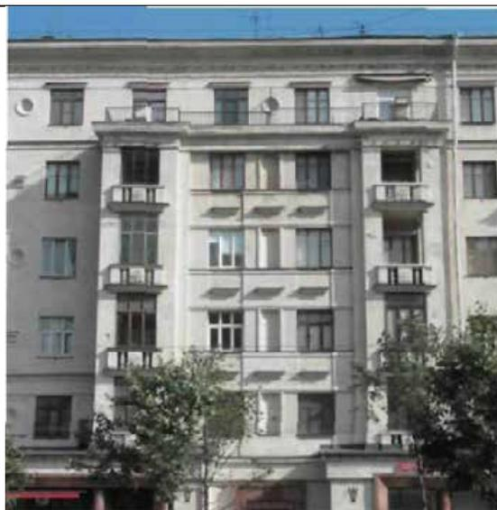
ризалиты фасада по Авиационной ул. на высоту 1-6-го этажей в три оси, в крайних осях лоджии на высоту 2-5-го этажей, карниз между 5 и 6 этажом, над осями лоджий замковые камни, ниша в средней оси полуциркульная в плане на высоту 2-5-го этажей;
