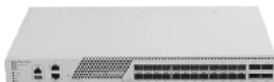
Рисунок 2 – Внешний вид коммутатора MES5324
