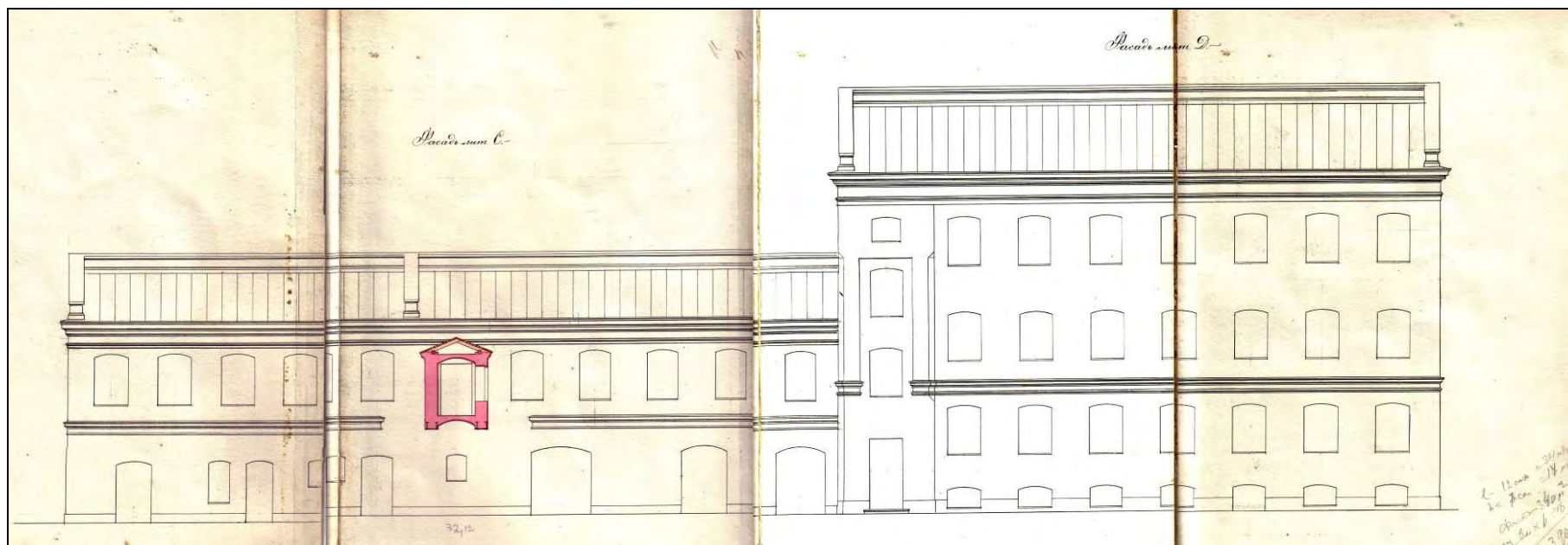
29. Фасады складского (лит. С) и производственного (лит. D) корпусов. В настоящее время – части корпусов лит. В и лит. Е. Гр. инж. Л.П. Андреев. 1897 г. // Архив фабрики «Светоч». Папка № 29, л. б/н.
