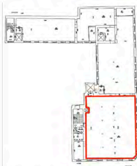
схема размещения конструкций «пруссских» сводов в уровне 2-го этажа
