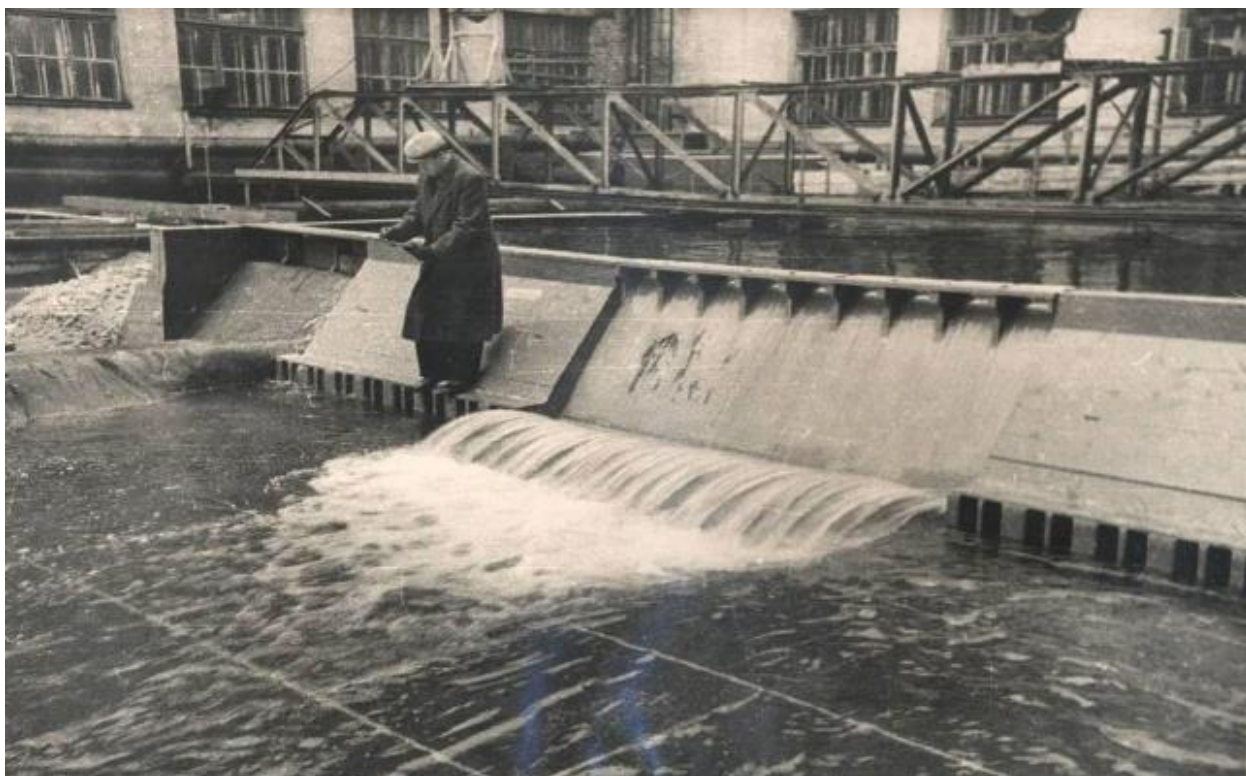
54. Проверка работы братской ГЭС по модели. Фото 1954-х гг. По материалам музея ОАО ВНИИГ им. Б.Е. Веденеева.
