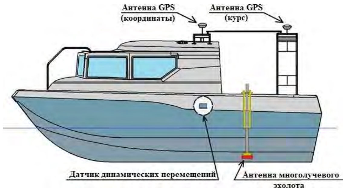
Рисунок 5.6 Схема установки оборудования на борту при работе на Участке №1
