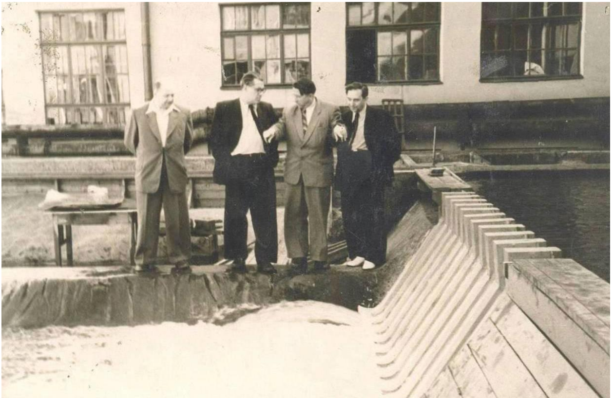
55. Проверка работы братской ГЭС по модели. Фото 1954-х гг. По материалам музея ОАО ВНИИГ им. Б.Е. Веденеева.
