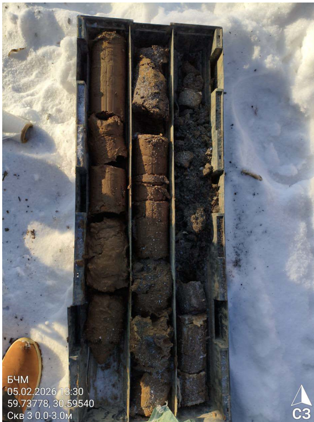
Фото 9. Выкладка керна скважина 3 (0,0-3,0 м)
