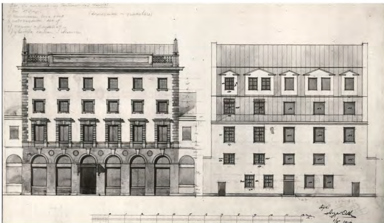
Илл. 178. Проект оформления фасадов Торгового дома А.П. Липина. Архитектор А.А. Оль. 195 г. ЦГАЛИ СПб Ф. 515. Оп. 1. Д.4. Л. 6 об. Надпись на чертеже: «Все, что желтым – из путиловской плиты».
