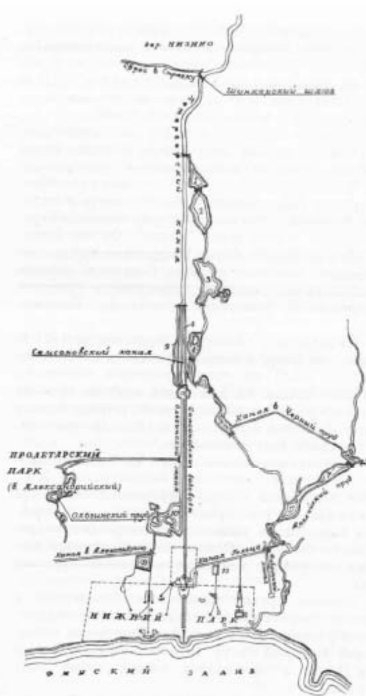
Схема Петергофского фонтанного водовода.
