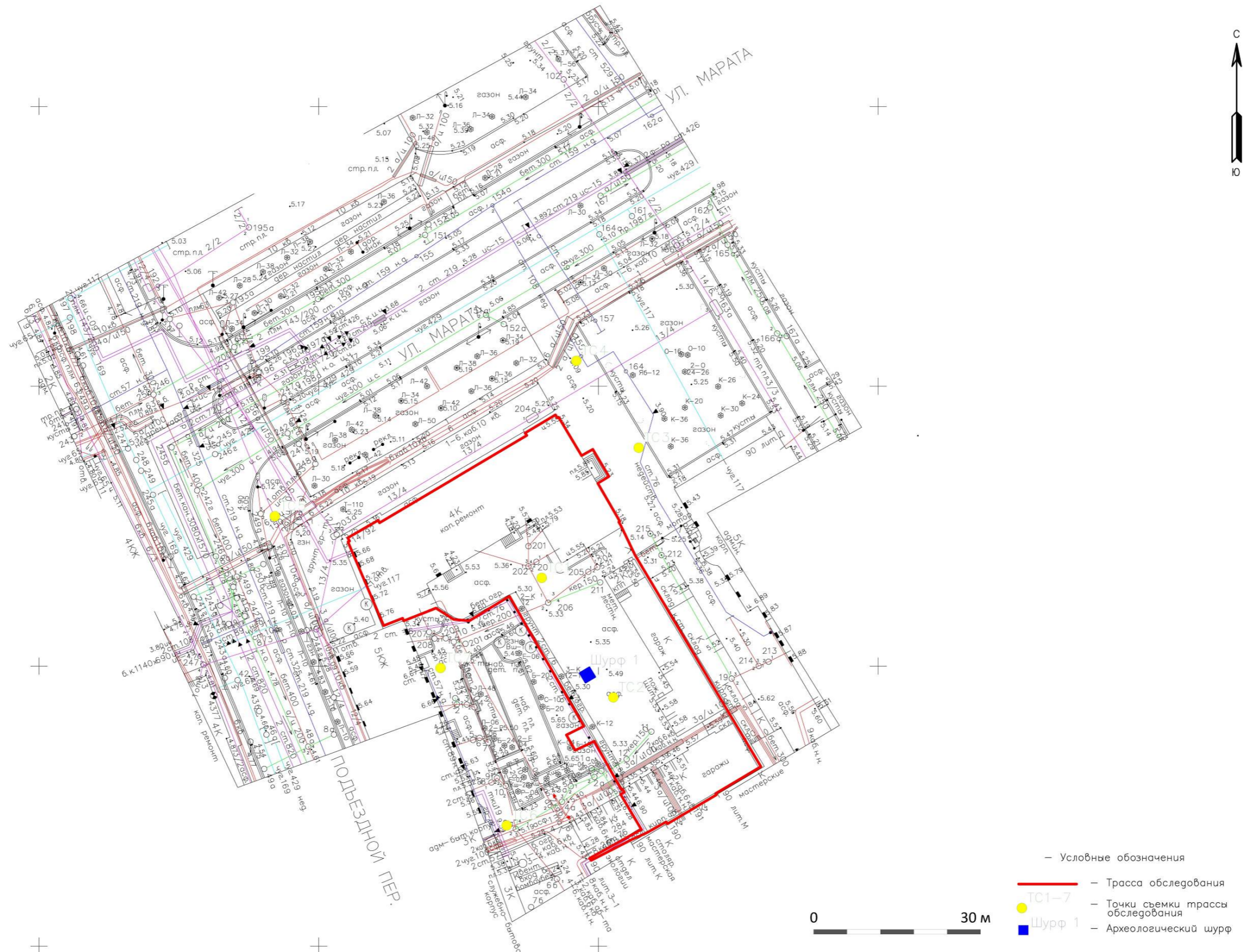
Рис. 7. Санкт-Петербург, Адмиралтейский район, ул. Марата, д. 92. Топографический план участка обследования с указанием мест заложения шурфов, точек съемки общих видов участка обследования
