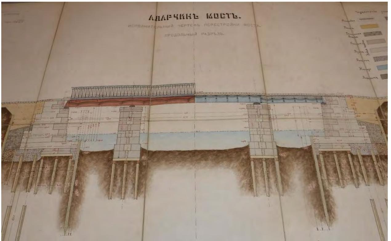
Ил. 27. Аларчин мост. Исполнительный чертеж перестройки моста. Продольный разрез.
