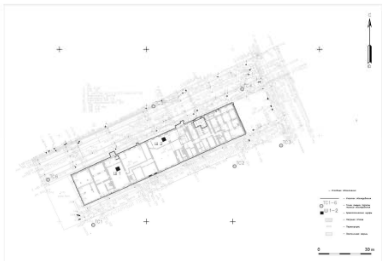
Рис. 10. Санкт-Петербург, Адмиралтейский район, Щепковой пер., д. 4-6, лит. А. Топографический план участка обследования с указанием мест заложения шурфов, точек съемки общих видов участка обследования
