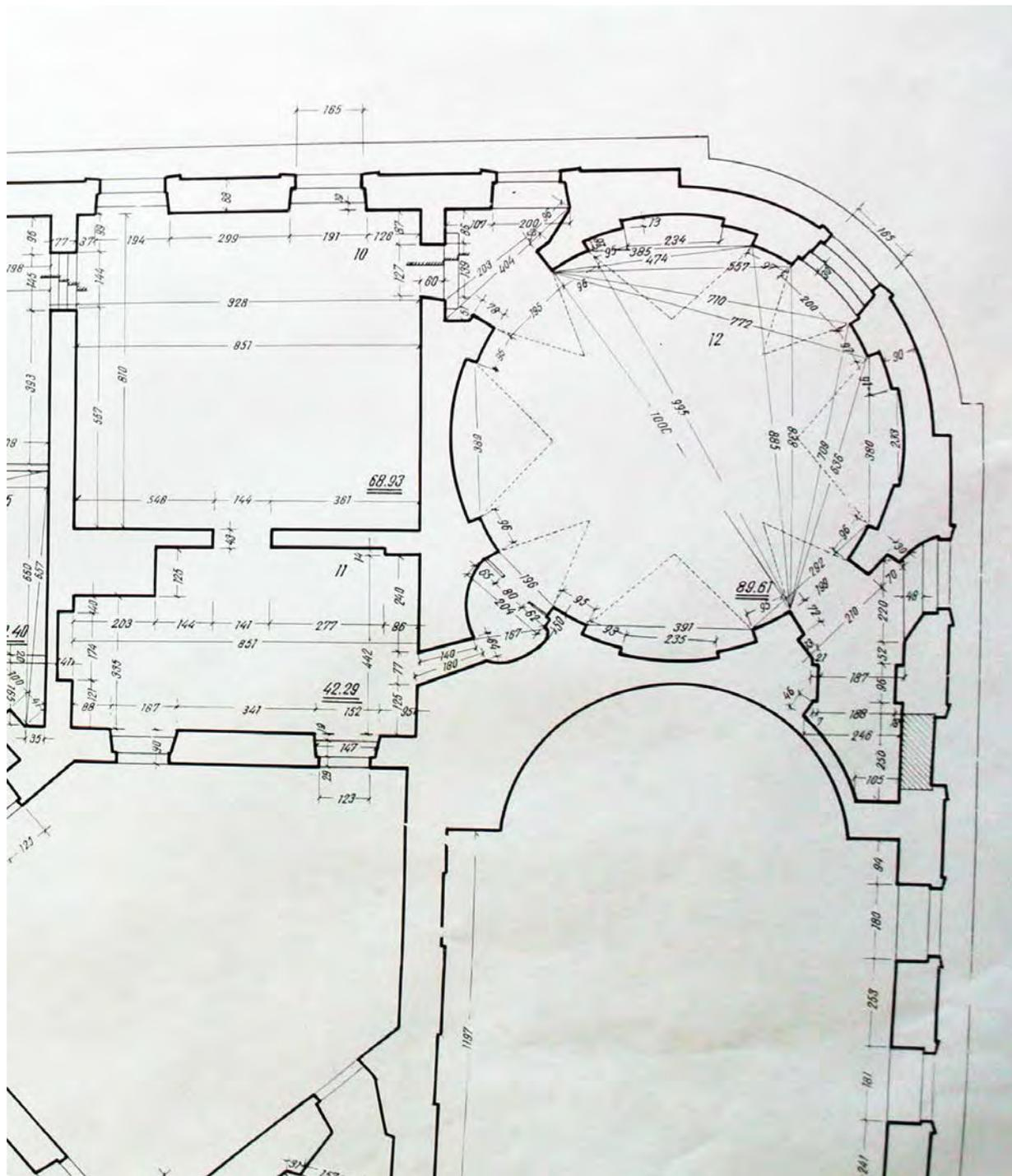
27. Обмерный план четвертого этажа замка.
