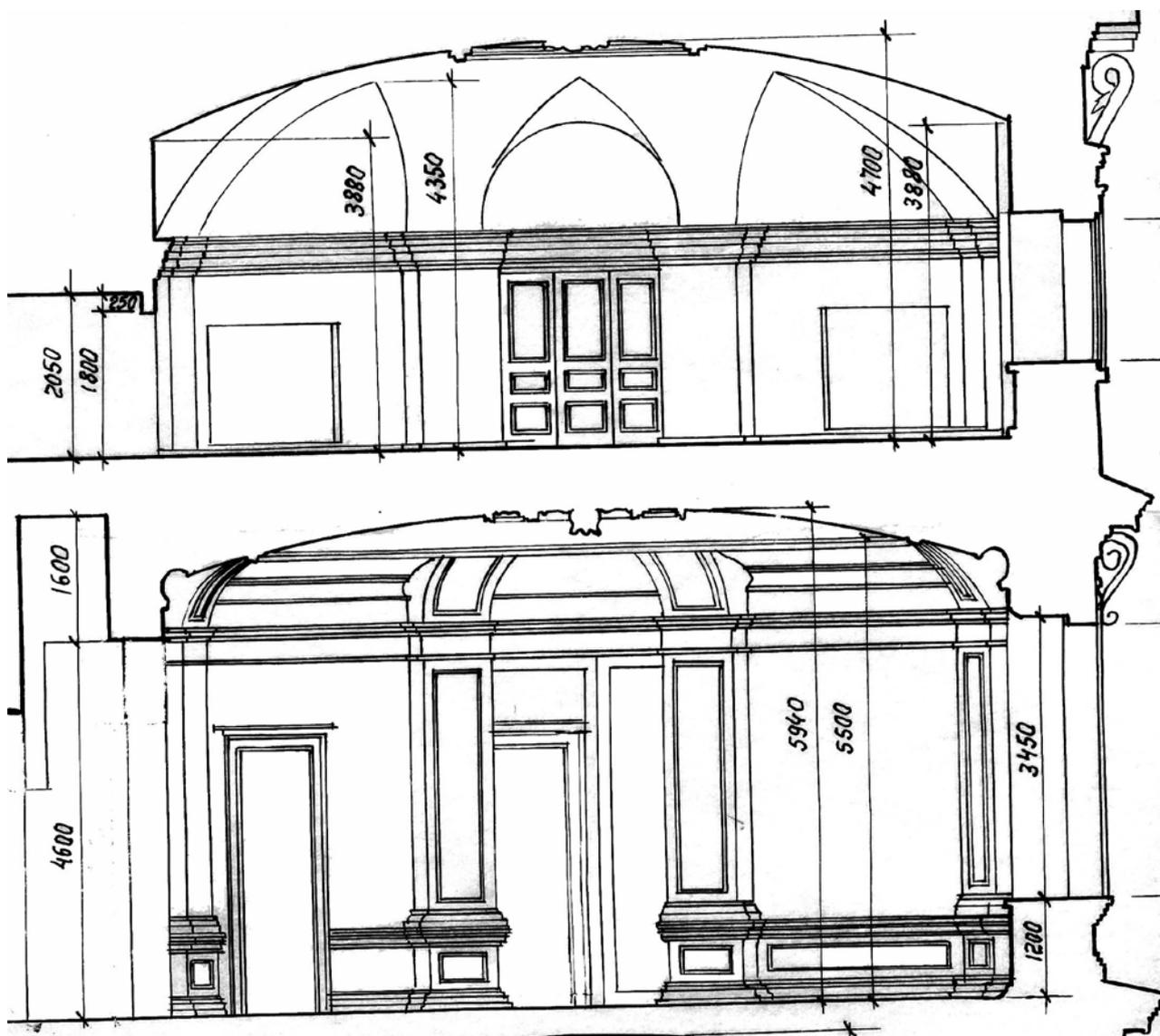
31. Разрез здания по оси бывшего Малого тронного зала.
