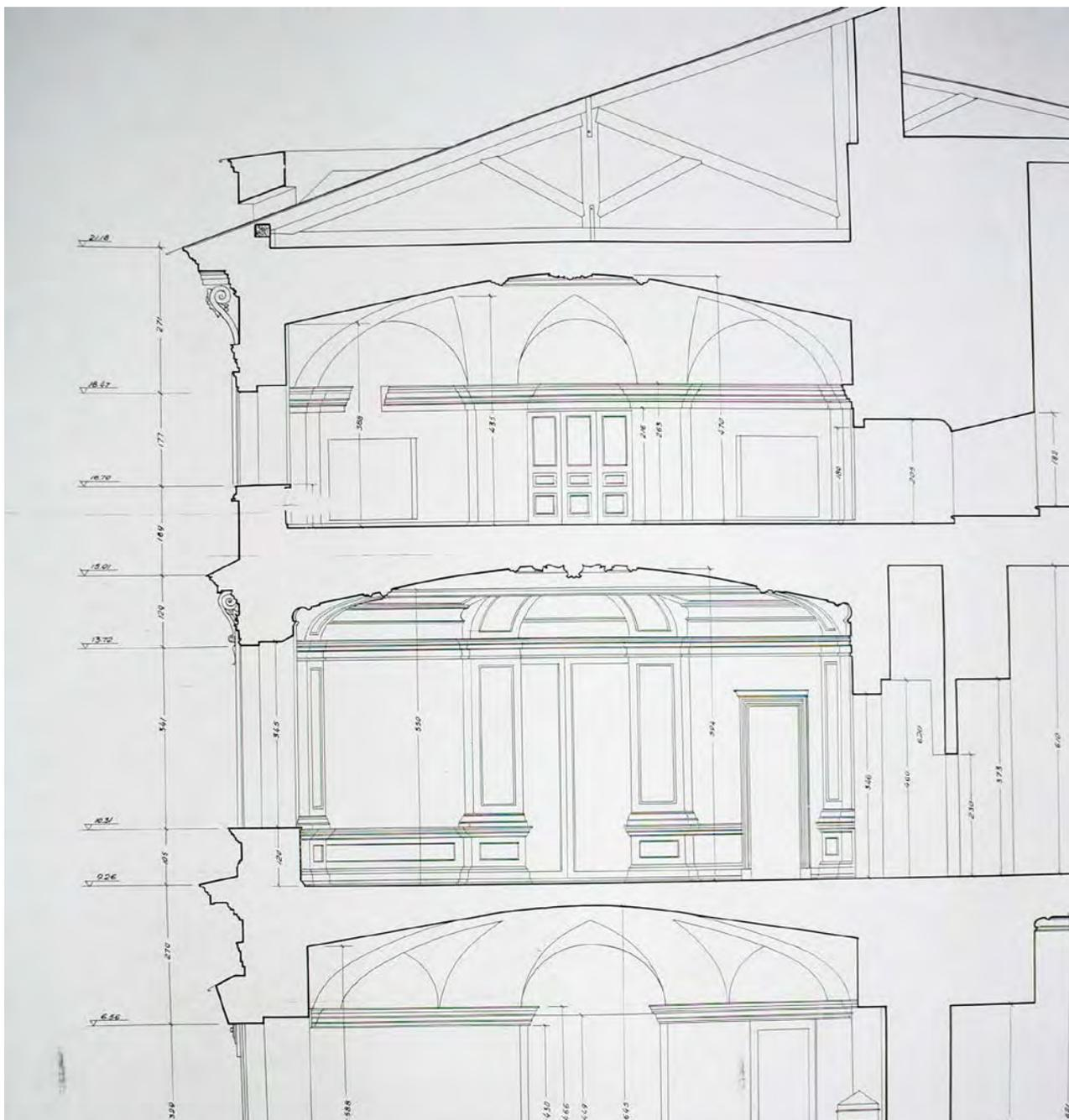
28. Разрез здания по оси бывшего Малого тронного зала.
