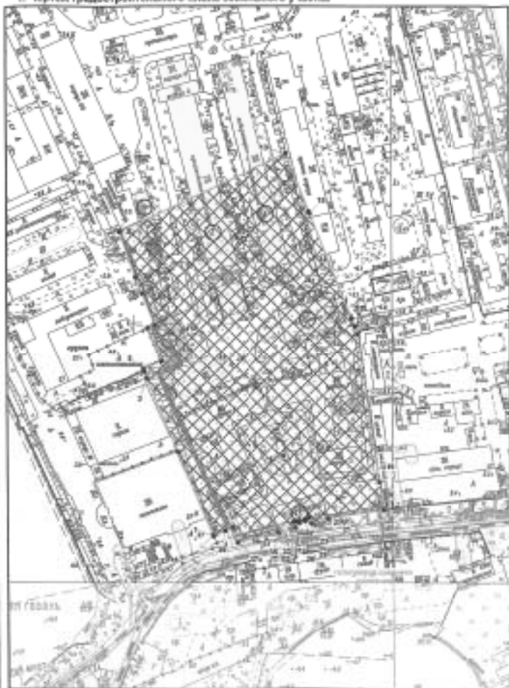
1. Чертеж градостроительного плана земельного участка
