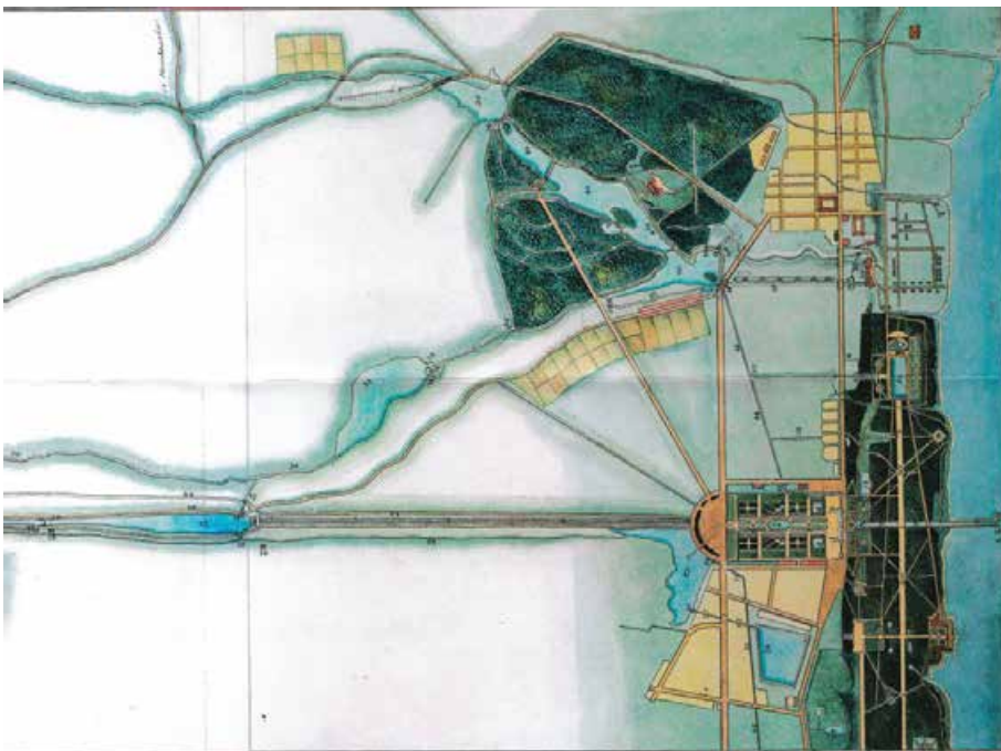
8. Вистингаузен Ф. фон. План водоподводящей фонтанной системы от деревни Симкино до залива с показанием шлюзов, плотин, прудов. Россия. 1824 г. Бумага, акварель, тушь. 62,3x95,4. (Фрагмент). Из кн. А.Л. Потравнов, Т.Ю. Хмелик «От реки Коваши до Самсоновской чаши. История водоподводящей системы фонтанов Петергофа. СПб., «Аврора», 2019, Вкладка №1 (1824).
