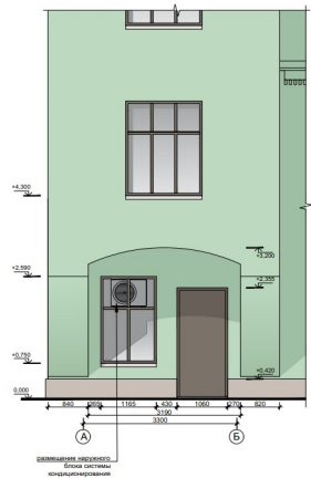
Проектируемый фасад с размещением доп. оборудования
