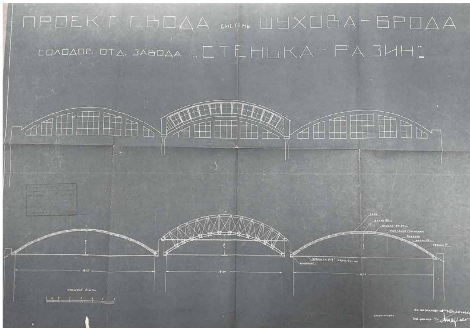
49. План свода системы Шухова-Брода солодового отделения завода «Стенька Разин». Фасад. Разрез. 1931 г. // ЦГА СПб. Ф. 2279. Оп. 5. Д. 1183. Л. 5.
