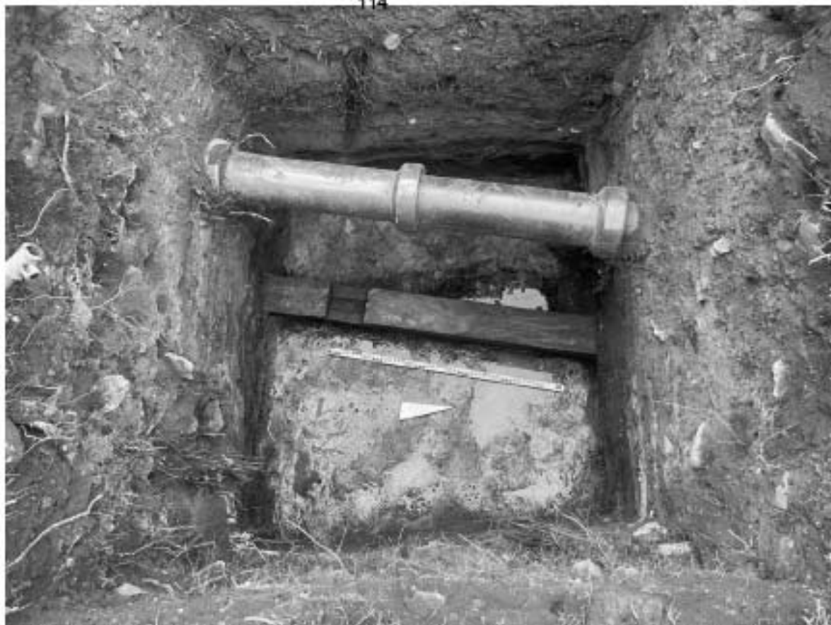
Рис. 35. г. Санкт-Петербург, г. Кронштадт, проспект Ленина, дом 39а, литера А (кадастровый номер: 78:34:1031501:3). Шурф 1. Уровень фиксации зачистки поверхности шурфа по материку и фрагменту деревянного дренажного короба. Вид с востока
