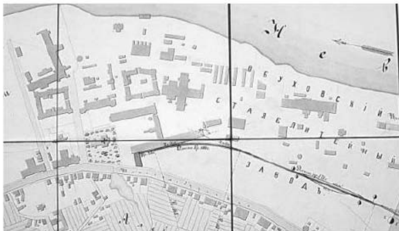
Ил. 13. План Обуховского сталелитейного завода, составленный в связи со строительством железной дороги соединяющей завод со станцией Обухово. 1885 г. Утвержден Строительным отделением Морского технического комитета 12.06.1885 г. РГИА. Ф. 350. Оп. 31. Д. 635.
