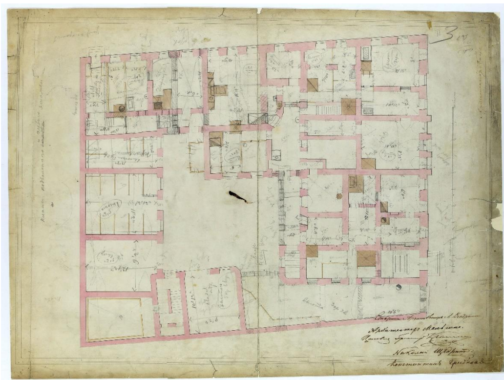
7. Арх. Г. Боссе. Дом В.Н. Карамзина План первого и первого этажей. 1851 г. ЦГИА СПб. Ф. 2005. Оп. 1. Д 49. Л.3.
