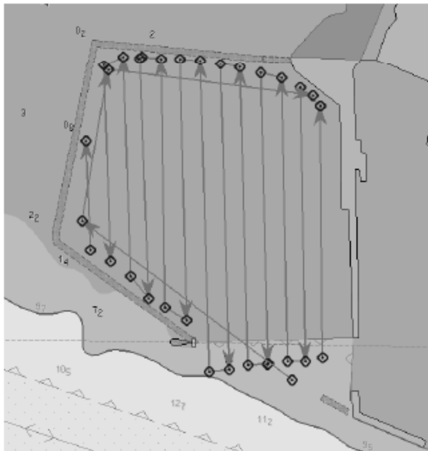
Рис. 89. Кронштадт. Каботажная гавань. Система профильной съемки и промерных галсов.
